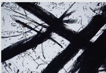
Изображение древесных волокон низкого качества с 45-кратным увеличением.
