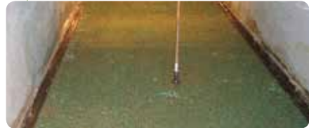
测试后耐用性结果显示，无植被 GreenArmor 7020 的临界剪应力为 5.8磅/平方英尺（276牛顿/平方米）。
