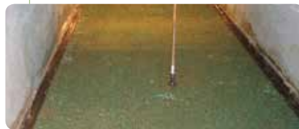
Результаты по долговечности после испытаний показали, что система GreenArmor 7020 без растительности обладает критическим значением напряжения сдвига 276 Н/м² (5,8 фунта/фут²).
