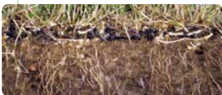
Показана система GreenArmor, демонстрирующая мощное развитие корней в укрепляющей матрице и под ней.
