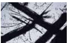
Fibra de madera inferior aumentada 45 veces.
